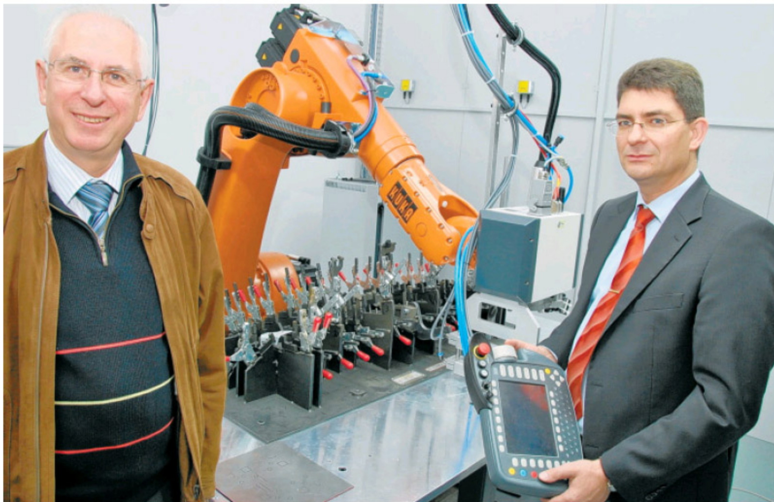
Laserschweißen: Juniorchef Uwe Bergmann – mit Vater Klaus Bergmann – steuert mit einem Bedienpanel den Roboterarm. Der bringt wiederum den Kasten mit dem neuartigen Faserlaser in Position.
