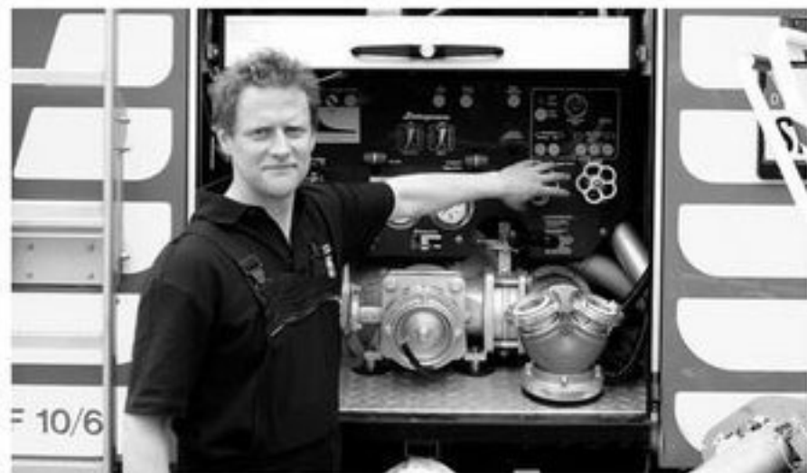
Begeistert dabei: Jan Volmar erklärt die Schaumzumischanlage an dem neuen Löschfahrzeug.
